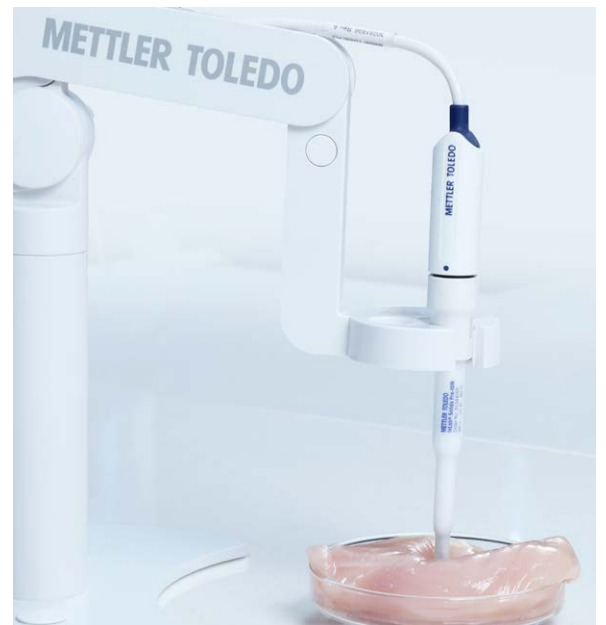
รูปที่ 3: การตรวจวัดค่า pH ของตัวอย่างเนื้อสัตว์ปอกโดยใช้เซ็นเซอร์วัดค่า pH รุ่น InLab Solids Pro-ISM
