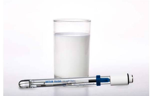
รูปที่ 3: การตรวจวัดนมโดยใช้เซ็นเซอร์วัดค่า pH รุ่น InLab Dairy
